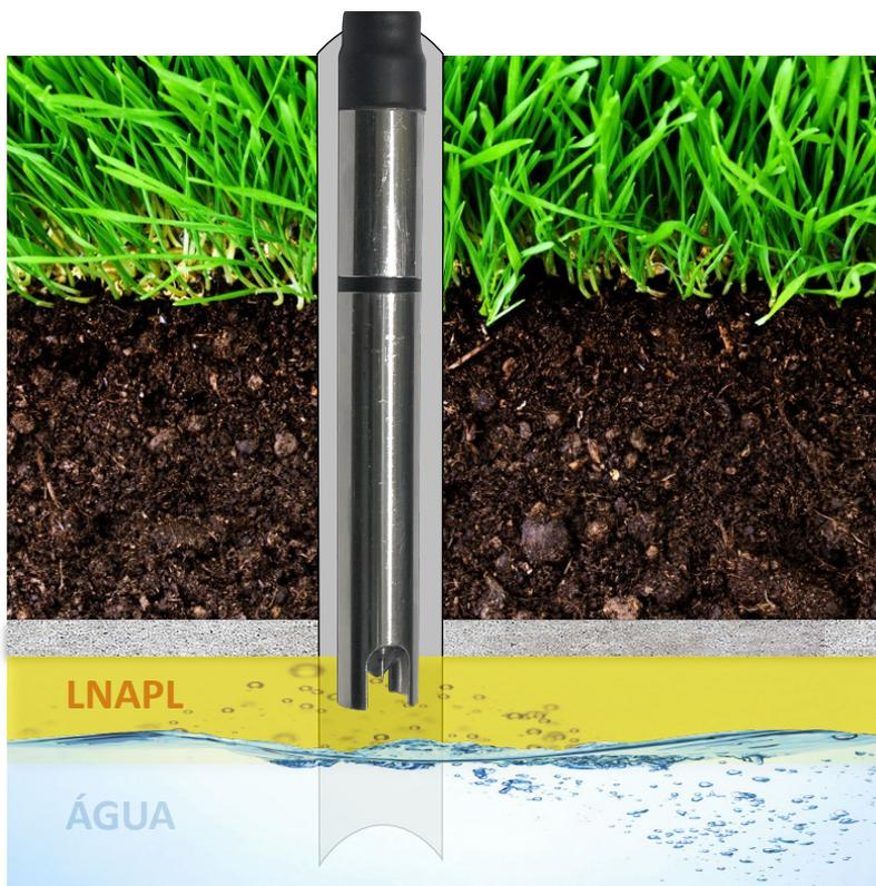
Quando a Sonda encostar na **fase livre**, indicará sinal sonoro intermitente lento piscando o Led na cor **VERDE** no painel.
